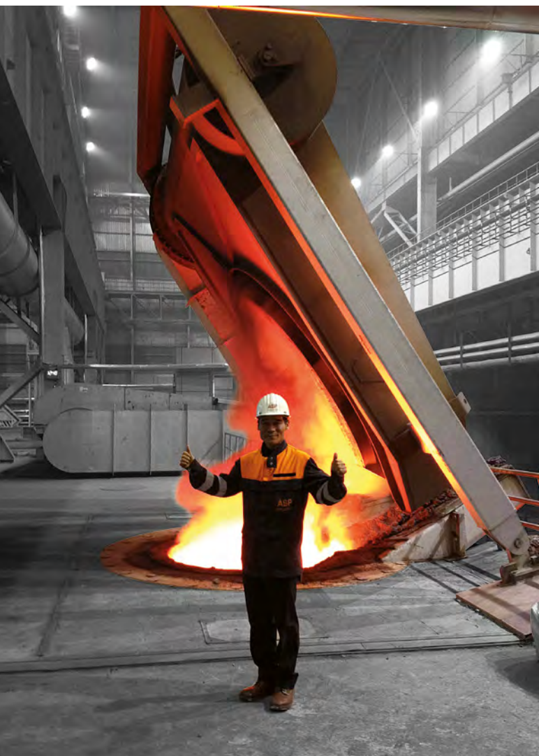
65 t-Tiefenanlage mit 42 MW-Schmelzleistung bei TISCO in China (Quelle: ABP)
